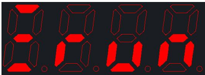
3#水泵运行(不使用互感器)
