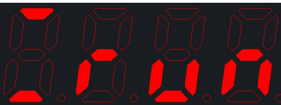
2#水泵运行(不使用互感器)
