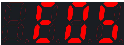
故障代号显示(外部电源故障)
