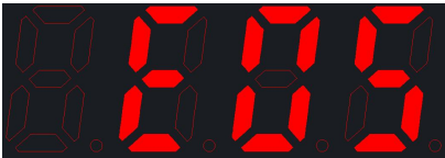
故障代号显示(外部电源故障)
