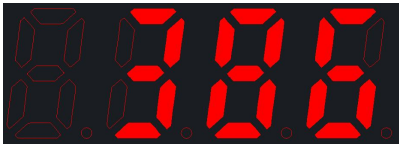
工作时显示 Uab 电压值（单位：V）
